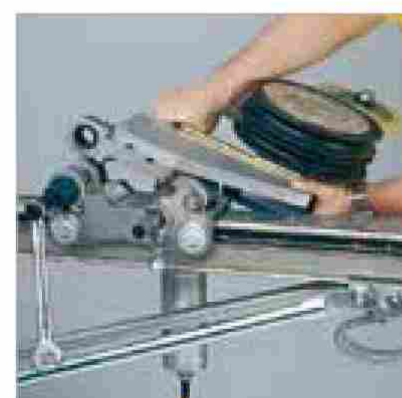
Быстрое переоборудование из сверлильной системы в канатную и наоборот
